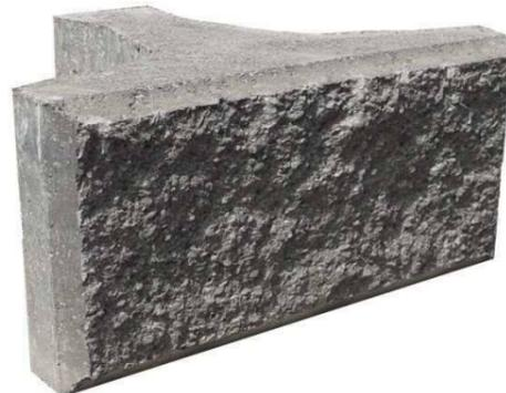
2個のブロックを一体成型で製造し、養生後に上下左右4面から圧力を加えて割ることで自然石のような割肌の2個のブロックが出来上がります。自然石の持っている温かさと親しみ・色彩と陰影を保ち、かつ使いやすさと経済性を生かした製品となります。
